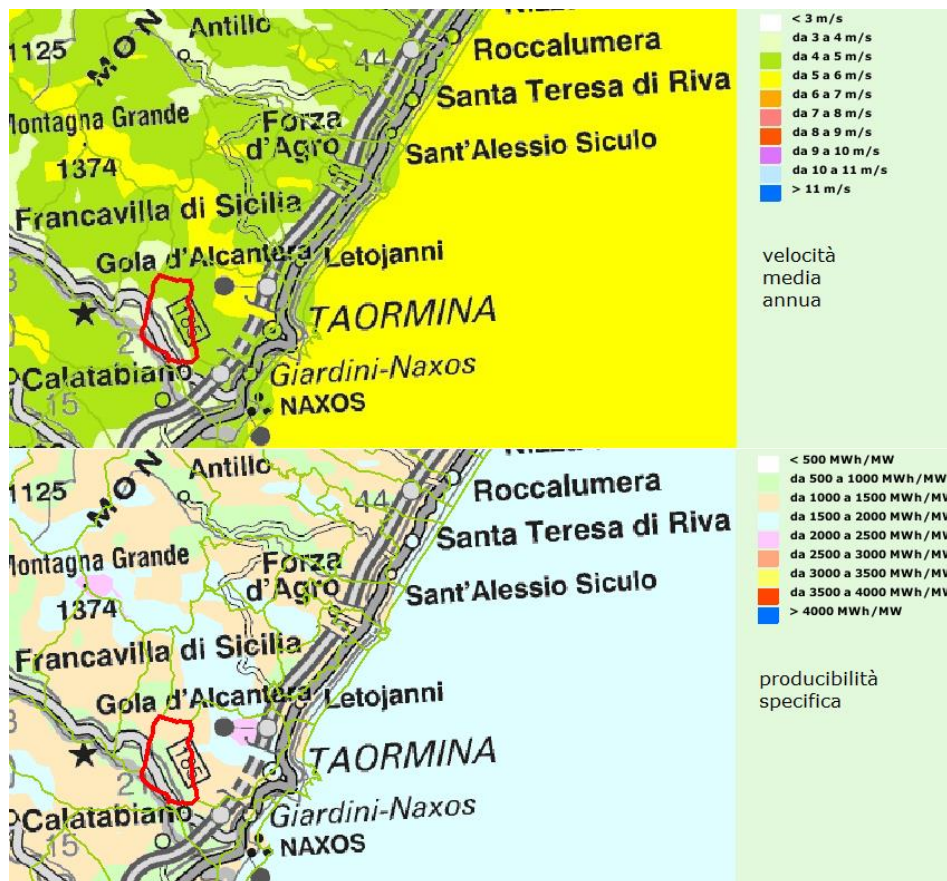
Figura 19. Velocità del vento e produttività specifica a 25 metri s.l.m. nel Comune di Gaggi.
